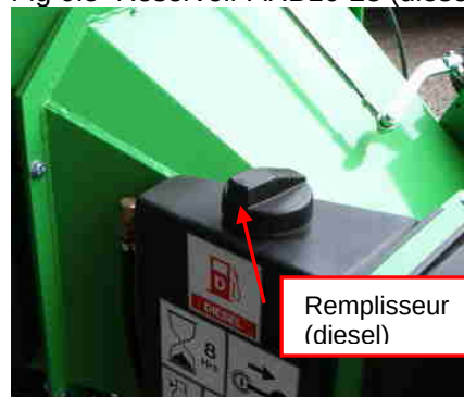
Fig 6.5 Réservoir ARB16-23 (diesel)
