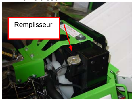
Fig.6.3a Liquide refroidissement ARB15-23 diesel
