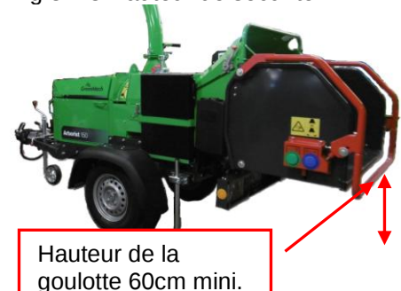
Fig 3.4.3 Hauteur de sécurité
