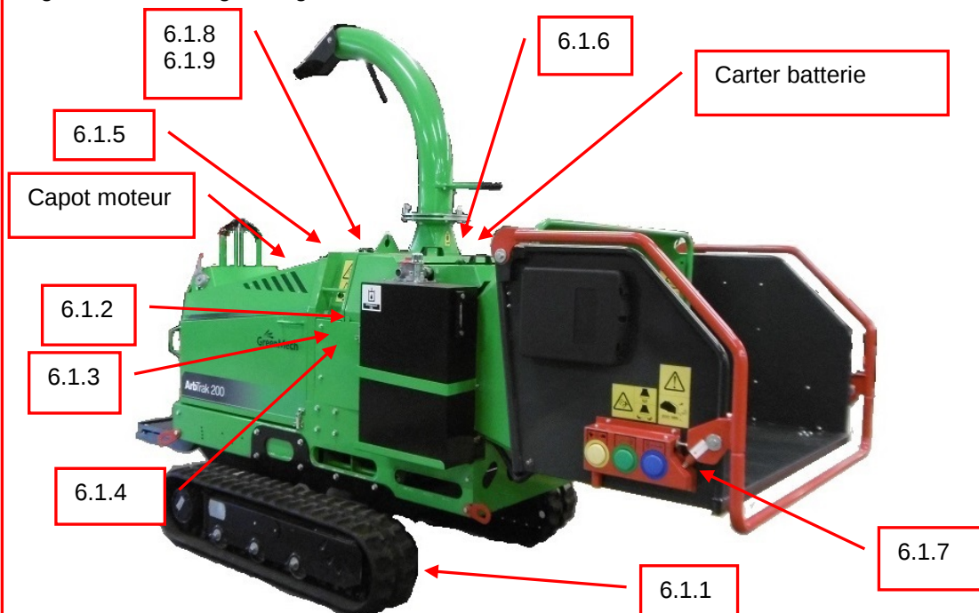
Fig 6.1b Points de graissage ArbTrak 200 modèle sur chenilles
