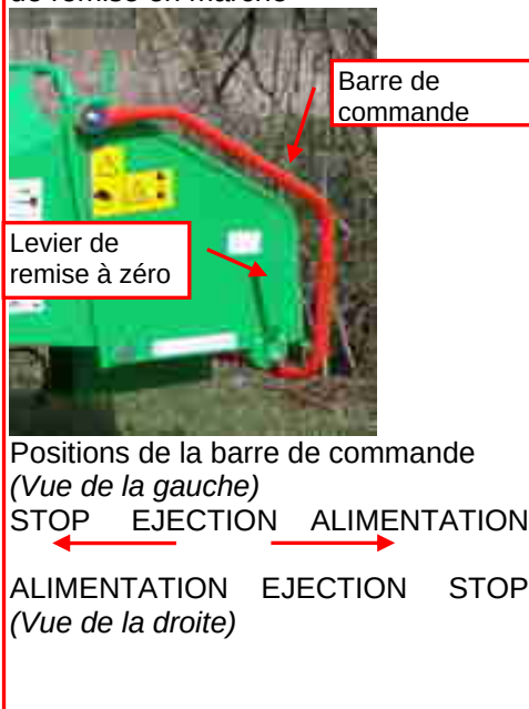
Fig 3.4.1 Barre de commande et levier de remise en marche
