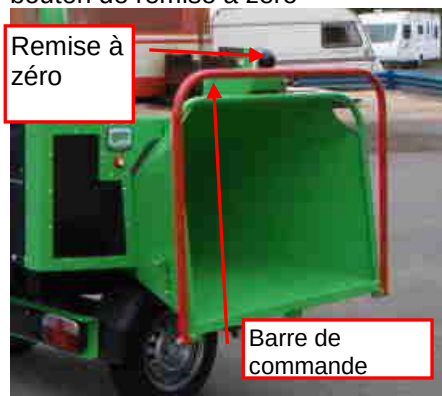
Fig 3.4.1 Barre de commande et bouton de remise à zéro
