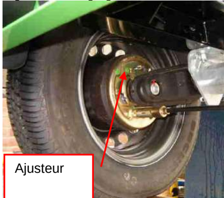
Fig 6.15.1 Réglage des freins
