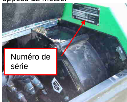
Fig 1.1 Plaque constructeur côté opposé au moteur
