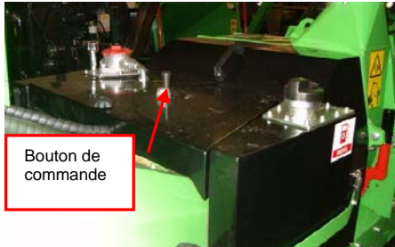
Fig. 5.8 Commande réglable des rouleaux ameneurs
